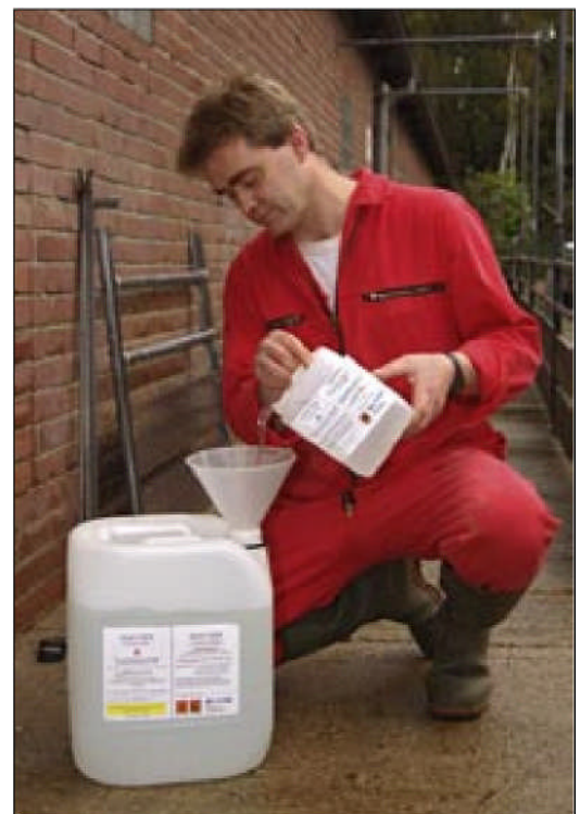
Das Chlordioxid wird vor Ort hergestellt, indem zwei Flüssigkeiten zusammengeschüttet werden. Die fertige Lösung ist sechs Wochen haltbar.
